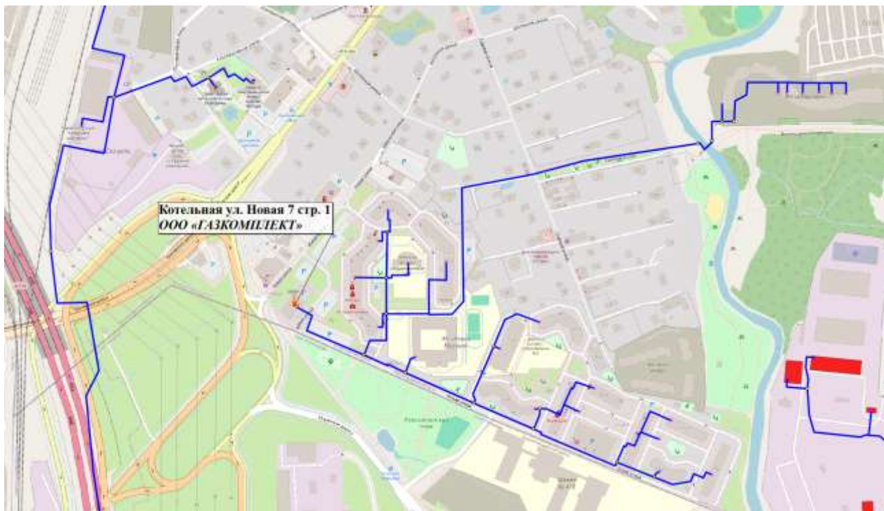
Рисунок 9. Схема тепловых сетей котельной ООО «ГАЗКОМПЛЕКТ» ул. Новая, д.7
