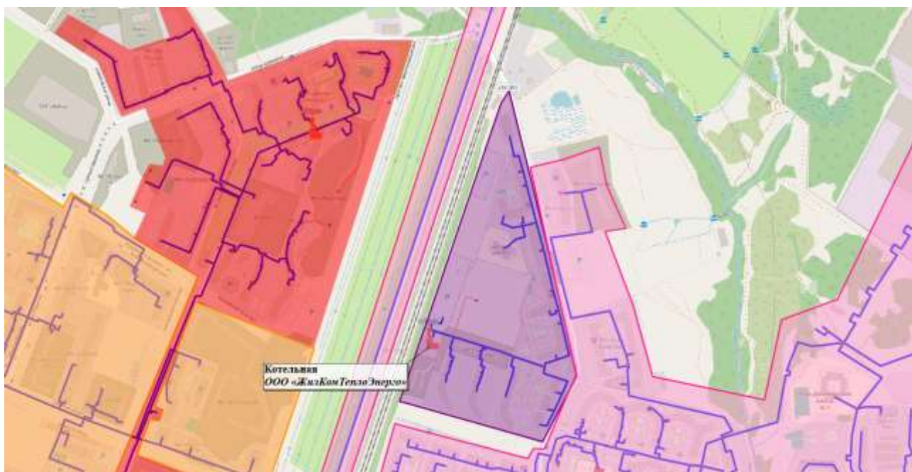
Рисунок 30. Зона действия котельной ООО «ЖилКомТеплоЭнерго»
