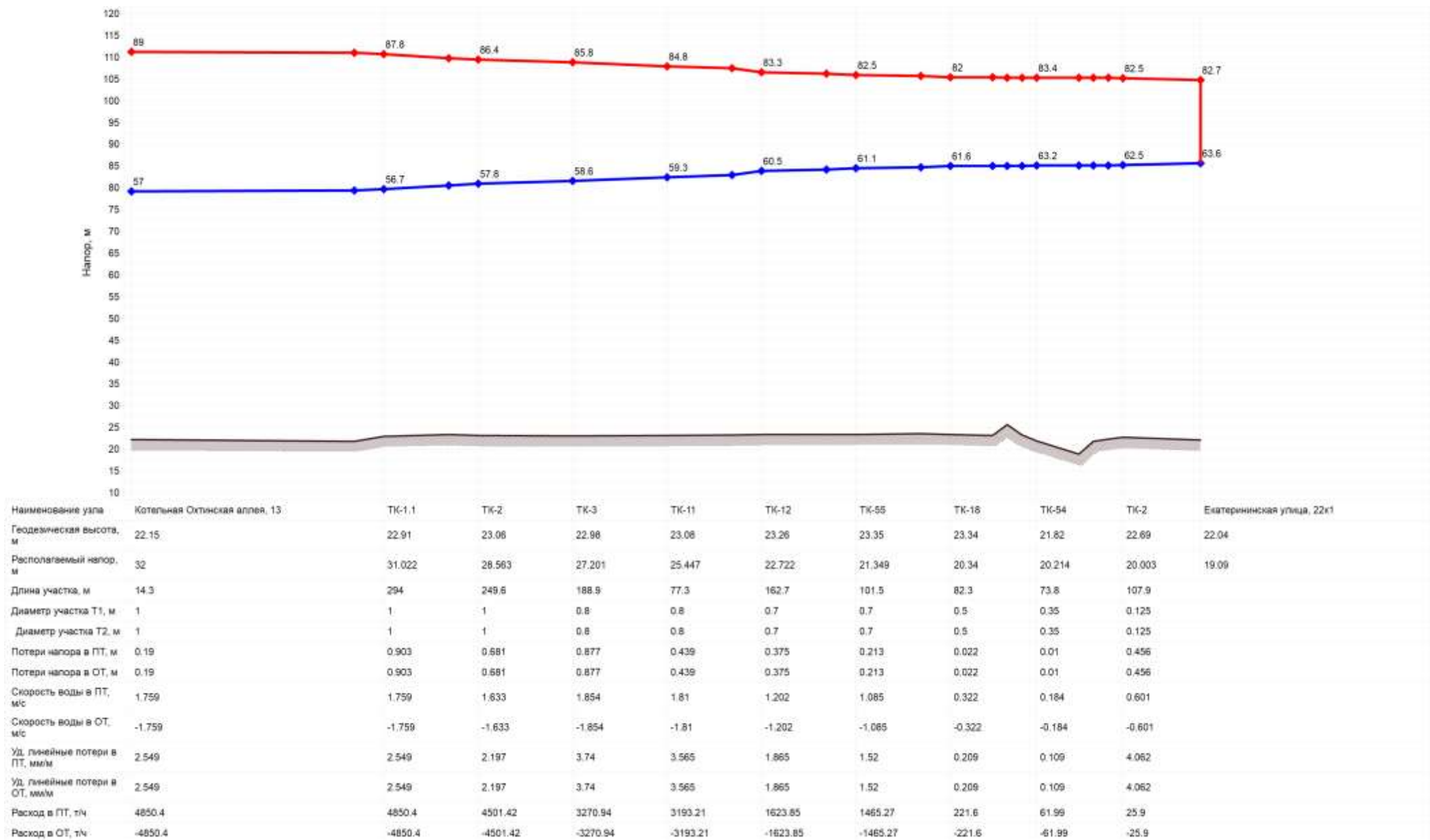
Рисунок 18. Пьезометрический график от котельной ООО «Петербургтеплоэнерго» до ул. Екатерининская, 23 к1
